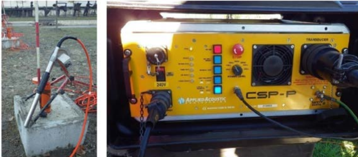
Figure 1.19 Illustration d'une source P : sparker (SolGéo).
