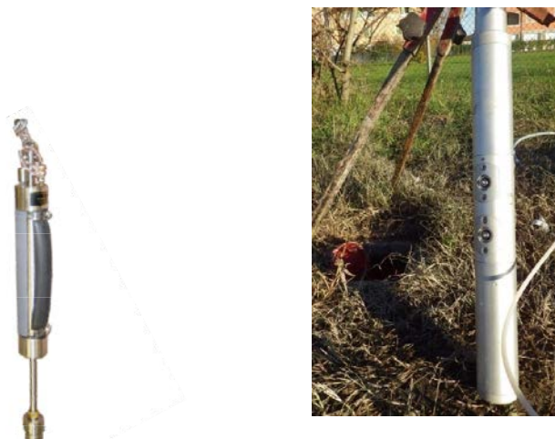
Figure 1.20 Illustration d'une source S mécanique (marteau-enclume Ballard) et électrodynamique (SolGéo, masse déplacée vers le haut ou le bas par un électroaimant).
