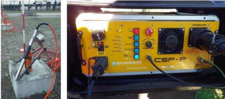
Figure 1.19 Illustration d'une source P : sparker (SolGéo).
