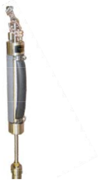
Figure 1.20 Illustration d'une source S mécanique (marteau-enclume Ballard) et électrodynamique (SolGéo, masse déplacée vers le haut ou le bas par un électroaimant).
