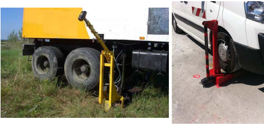
Figure 1.4 Illustration d'une source S utilisée en downhole et conforme à la norme ASTM (gauche, source IgeoTest ; droite, source IMG).
