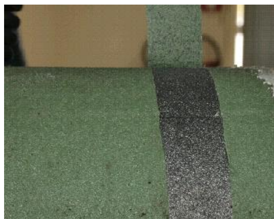
Figure 7 : Pelage d'un revêtement FBE + adhésif vieilli 28 j dans l'eau déionisée à 60°C
