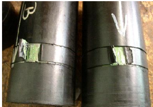
Figure 2 : Pelage de revêtement tricouche non rainuré vieillis 21 jours dans l'eau déionisée à 20°C (gauche) ; à 60°C (droite)
