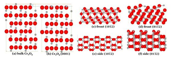
**Fig. 2.** (a) Bulk  $Cr_2O_3$ ; (b)  $Cr_2O_3$  (0001); (c)  $Cr_2O_3$  (10 $\overline{1}2$ ); (d)  $Cr_2O_3$  (01 $\overline{1}2$ ); side view (10 $\overline{1}2$ ) and (f) side view (01 $\overline{1}2$ ).
