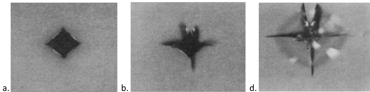
Figure 1.22 : Endommagement sur la surface de contact des verres sodo-calciques pendant un cycle d'essai d'indentation Vickers avec une force maximale P_{max} = 40 \text{ N} : (a) pendant la charge (50 % de P_{max} ), (b) pendant la décharge (68 % de P_{max} ), (c) fin de décharge [82].
