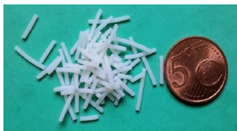
Figure 2.1: Lot d'extrudés cylindriques en alumine \gamma fabriqués par IFPEN
